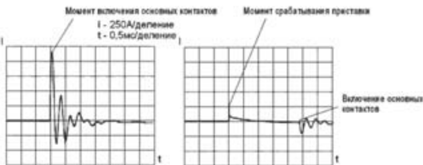
Рис. 1. Работа контакторов без упреждающих контактов
